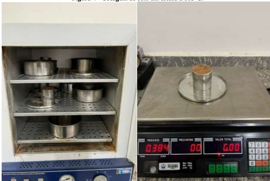
Figura 4 – Secagem do solo em estufa á 105°C.
