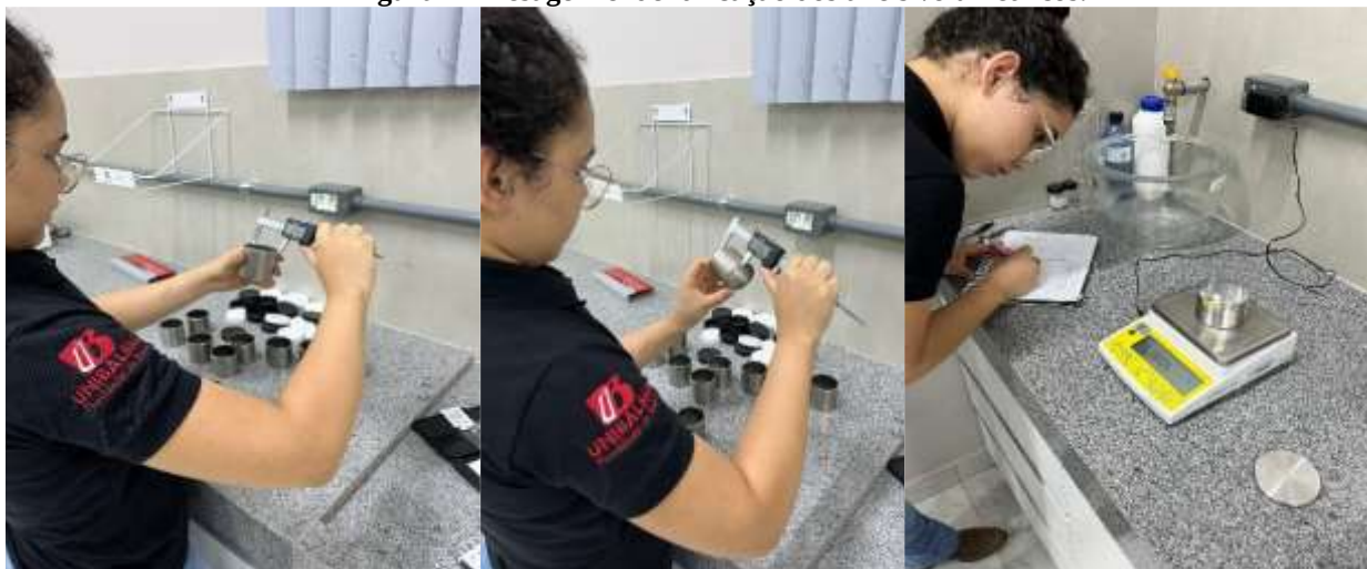
Figura 2 – Pesagem e identificação dos anéis volumétricos.
