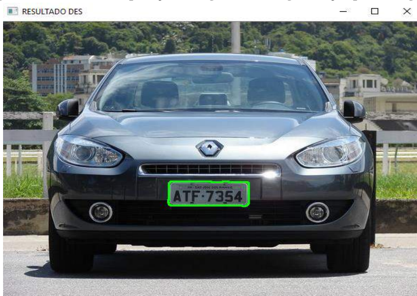
Figura 9: Resultado da aplicação do algoritmo de segmentação por retângulos.
